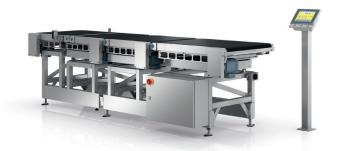
La báscula automática HC-FL-T-2 convierte tres básculas físicas en seis básculas virtuales. Todas las básculas pueden trabajar independientemente. Esta capacidad debida a su diseño permite mantener unas distancias mucho más cortas entre los productos. El principio de la báscula triple proporciona un aumento en el rendimiento del 60 % a la misma velocidad, en comparación con las básculas simples, a la vez que garantiza un óptimo rendimiento y durabilidad.
