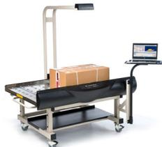
Combina los atributos de flexibilidad, precisión y durabilidad en un único equipo de medición de objetos regulares. Montado sobre ruedas, puede estar en una posición fija o moverse con facilidad.
